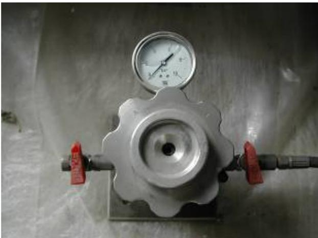
Fig 1: Cámara de medida de potencial hídrico foliar
